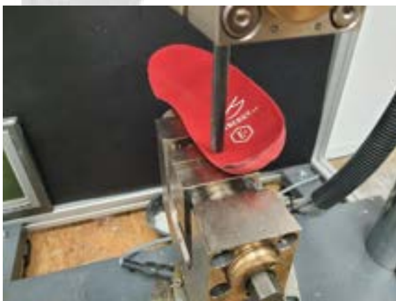
rys. Badani właściwości mechanicznych wkładek na maszynie wytrzymałościowej
