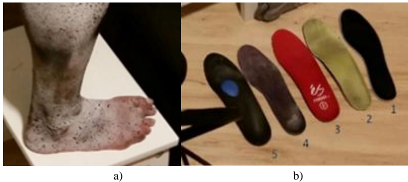
Ryc. 2 Stanowisko pomiarowe z różnymi rodzajami wkładek: a) kończyna pokryta b) wykorzystane w pracy wkładki obuwnicze.
