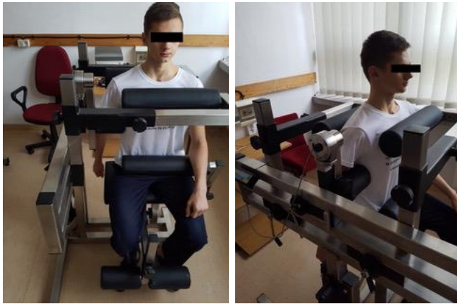
Ryc. 1 Schemat stanowiska pomiarowego do oceny momentów sił mięśniowych stawu ramiennego.
