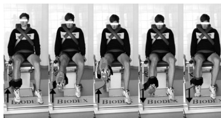
Ryc.1. Pomiar momentów sił prostowników i zginaczy stawu kolanowego na stanowisko pomiarowym BIODEX System 4 Pro.
