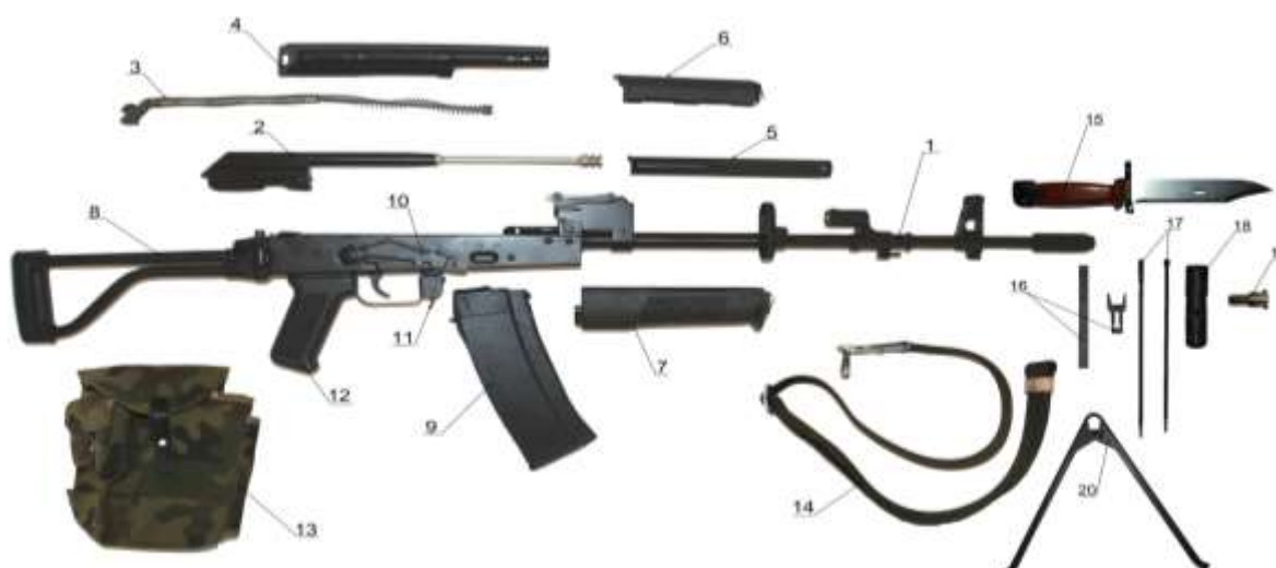
Rys. 15 Widok ogólny 5,56 mm karabinu szturmowego – wariant A; b- Zasadnicze części i zespoły karabinu: 1 – komora zamkowa z lufą; 2 - suwadło z zamkiem; 3 – urządzenie powrotne; 4 – pokrywa komory zamkowej; 5 – rura gazowa; 6 – nakładka; 7 łoże; 8 – kolba z osadą; 9 magazynek; 10 – bezpiecznik; 11 – zatrzask magazynka; 12 – rękojeść; 13 – torba na magazynki; 14 – pas do broni strzeleckiej; 15 – bagnet; 16 – łódka z nasadką; 17 – wycior; 18 – przybornik z przyborami; 19 – odrzutnik do ślepego strzelania; 20 – dwójnóg.
