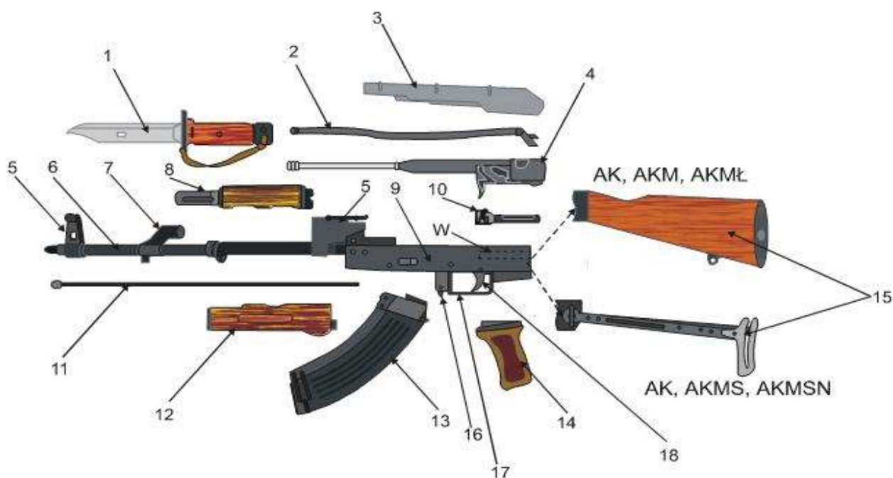
Rys. 13. 1- bagnet 2- urządzenie powrotne 3- pokrywa komory zamkowej 4- suwadło z tłokiem gazowym 5- przyrządy celownicze (muszka, szczerbinka) 6 - lufa 7- komora gazowa 8- rura gazowa z nakładką termiczną 9- komora zamkowa z mechanizmem spustowym i przełącznikiem rodzaju ognia 10- zamek 11- wycior 12- łoże 13- magazynek 14- rękojeść 15- kolba (drewniana, metalowa składana)
